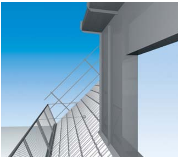
Bild 5 Dachfangwand, ungeeignet für Arbeiten auf Lukarnen und Dachgauben.
