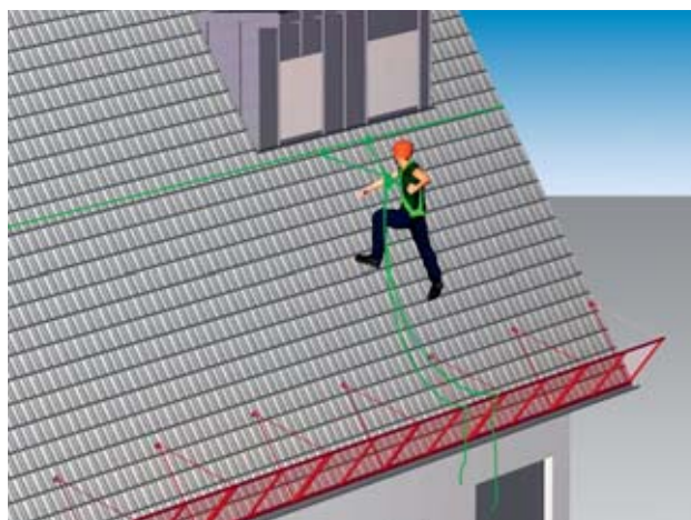
Bild 14 Arbeit am hängenden Seil. Als Zusatzmassnahme wurde eine Dachfangwand montiert, um herunterfallendes Material aufzufangen.
