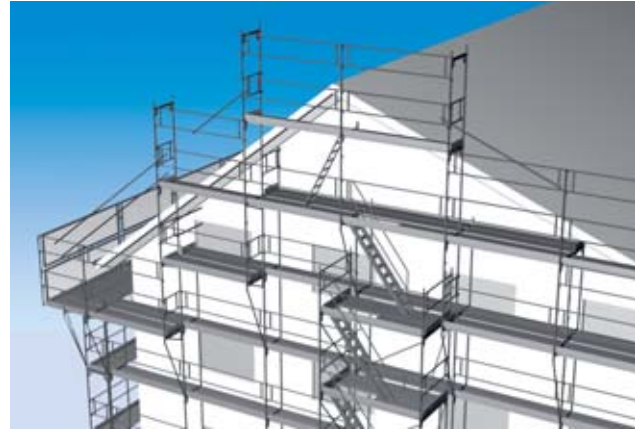
Bild 1 Kollektivschutz in der Bauphase
